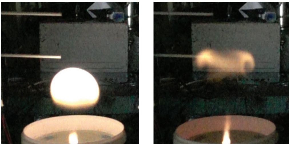
Рис. 12. Переход плазмоида из шаровой формы (а) в тороидальную (б) в одном разряде Pic. 12. Transition of a plasmoid from a spherical shape (a) into a toroidal shape (b) in a single discharge
