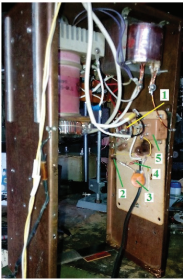
Рис. 6. Коммутатор импульсный тиратрон ТГИ1-500/16 и плата управления тиратроном в собранном виде
