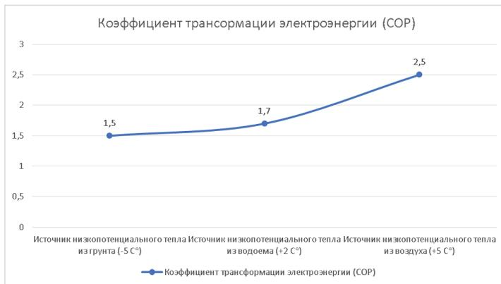
**Рис. 6.** График зависимости коэффициента трансформации электроэнергии (COP) от температуры источника
